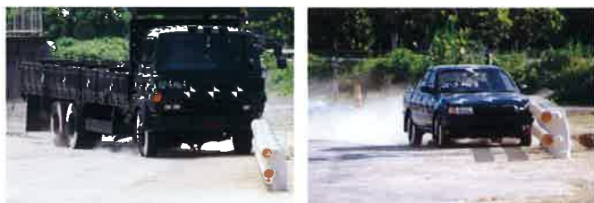
つくば市 国土政策総合研究所内衝突実験施設での衝突実験状況 左：大型貨物車 右：乗用車
