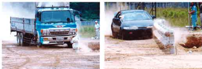
自社の衝突実験施設での衝突実験状況 左：大型貨物車 右：乗用車
